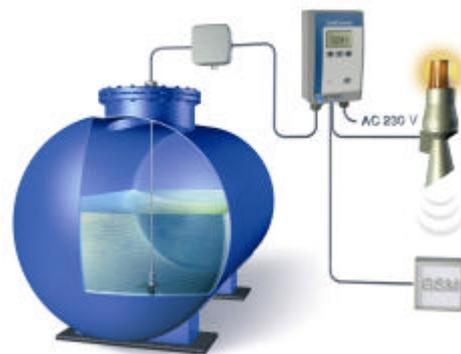
**TankControl 01**, Füllstandmesscomputer für Heizöl, inkl. Sensor und Tank-Verschraubungsset
