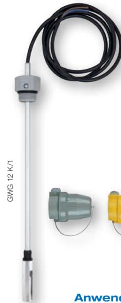
**Anwendung** Einsatz als Teil einer Steuerkette für Abfüllsicherungen zur Vermeidung von Überfüllungen von Behältern. Für Batterietanks aus Stahlblech nach DIN 6620-1 Form B, standortgeschweißte Rechtecktanks nach DIN 6625-1 in Bauhöhen 1 bis 4 m und für Kunststoff-Behälter, auch in Batterieaufstellung (bis zu 25 Einzelbehälter). Geeignet für den Einsatz in hochwassergefährdeten Gebieten.
