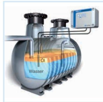
**Anwendung** Öle, Fette und Benzin stellen hohe Gefährdungspotenziale für Grund- und Abwasser dar. WGA 01 überwacht die Schichtdicke der abgeschiedenen Flüssigkeit in Öl-, Benzin- und Fettabscheidern und gibt Alarm, wenn der Abscheider entleert werden muss. Außerdem kann der maximal zulässige Füllstand im Abscheider detektiert werden. Eine Überfüllung, z.B. durch einen verstopften Ablauf, kann verhindert werden. Der Eintritt von Schadstoffen in die Kanalisation wird vermieden.
