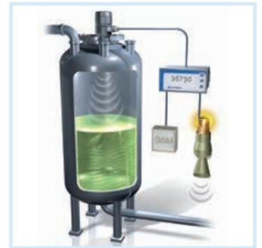
**Anwendung** Zur kontinuierlichen, berührungslosen Füllstandmessung bei Medien unterschiedlicher Konsistenz und Oberflächenbeschaffenheit. Ideal für die Füllstandmessung von Flüssigkeiten und Schüttgütern.
