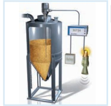
**Anwendung** Zur kontinuierlichen Füllstandmessung in Behältern, Tanks oder Silos. Geeignet für flüssige, pulvrige, feste, elektrisch leitende oder nicht leitende Medien. Ideal für wechselnde Medien. Auch für Behälter, die unter Druck oder Vakuum stehen.
