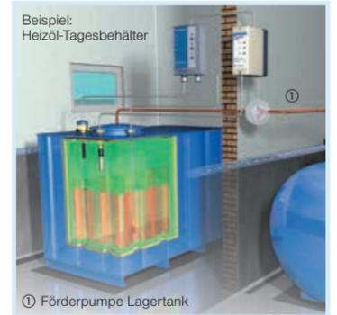
**Anwendung** Einsetzbar für elektrisch leitende und nichtleitende Flüssigkeiten, die nicht dickflüssig oder anhaftend sind: Heizöl, Dieseldieselkraftstoff, Emulsionen, Wasser, nichtaggressive Medien.
