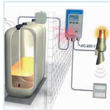
**Anwendung** Kontinuierliche Füllstandmessung mit graphischer Anzeige zur Verbrauchsdarstellung (Historie), Reichweitenermittlung (Prognose) sowie Meldung von Minimalfüllständen (Reservemeldung). Geeignet für Behälter von 900 bis max. 4.700 mm Füllhöhe. Für Heizöl EL, L, Dieselkraftstoff und FAME 100 % als Biodiesel (EN 14214). Speziell konzipiert für die Haus- und Gebäudetechnik. Geeignet für den Einsatz in hochwassergefährdeten Gebieten - Wasser (bis 4 m Füllhöhe)
