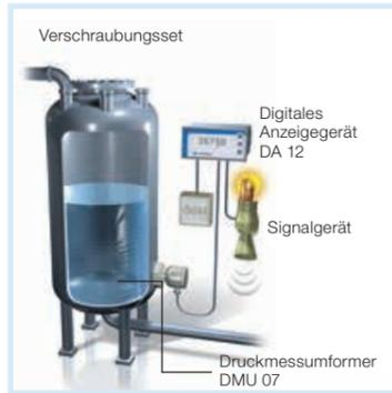
**Anwendung** Universeller Einsatz zur Messwertanzeige (DA 10), alternativ mit zusätzlichen Relaisausgängen (DA 12/14) für elektronische Messumformer.
