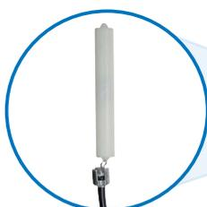
Schwimmende Entnahme nach Empfehlungen der DIN 4755. Ermöglicht die Heizölentnahme im sauberen Bereich und unterstützt so die optimale Funktion nachfolgender Armaturen (z. B. Ölfilter).
