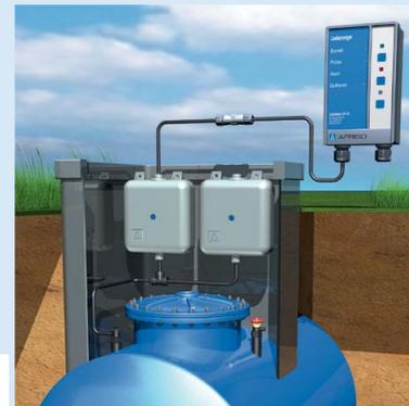
**Anwendung** Für doppelwandige Behälter mit Flüssigkeit im Überwachungsraum. Zur Überwachung bei oberirdischer Lagerung brennbarer Flüssigkeiten der Gefahrklasse A I, A II, A III, B (nach ehemaliger Einstufung VbF) und nichtbrennbarer wassergefährdender Flüssigkeiten. Zugelassen für Tanks nach EN 12285-1, 12285-2, DIN 6618-B, 6619, 6623 und DIN 6624 unter atmosphärischen Bedingungen.
